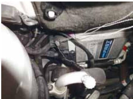
Alle relevanten Fahrzeugteile wurden durch den TÜV Nord verplombt, um Manipulationen während des Tests auszuschließen.
